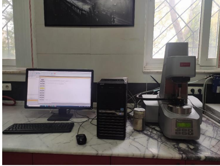
Şekil 2.2. Numunelerin yüksek sıcaklık performanslarının DSR cihazı ile ölçülmesi
